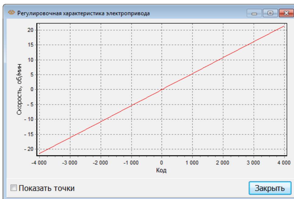
Рис. 48. Графическое отображение регулировочной характеристики ЭП
